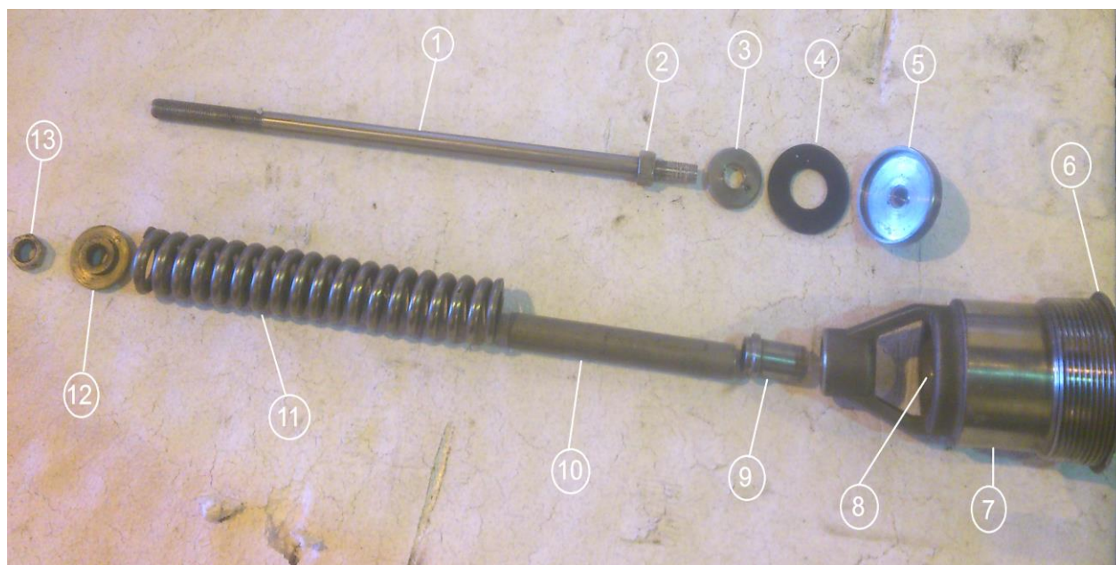
4-5-4- جنس قطعات سوپاپ اطمینان REGO RELIEF VALVE مدل A8436N
